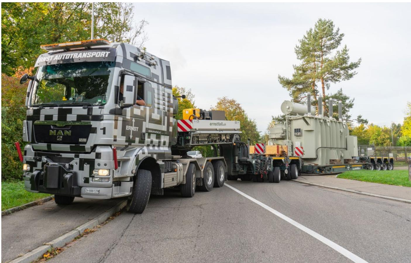
↑ Für den Transport eines 62 Tonnen schweren Trafos ist ein passender Lastwagen mit entsprechendem Anhänger unerlässlich.
